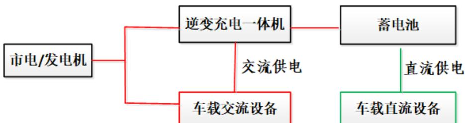
车辆配备多种电源接入方式：1) 通过大容量蓄电池、逆变充电一体机、为车内设备提供交、直流电源。2) 可通过防水插座直接与市电或者发电机连接，为车内工作提供持续的供电，并同时为车载蓄电池组进行充电。3) 通过与原车电池的并联，在警车和怠速状态下可长时间为车辆提供交、直流电源，并通过隔离保护器防置原车电池亏点。
