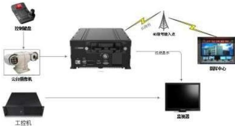
监控系统由高清监控摄像机、高清硬盘录像机和监视器组成。高清监控摄像机所采集的音、视频数据可被高清硬盘录像机压缩并存储，同时视频可由高清硬盘录像机实时解码，在监视器上播放出来。4G 传输模块需要根据用户现有平台建设情况进行沟通定制。
