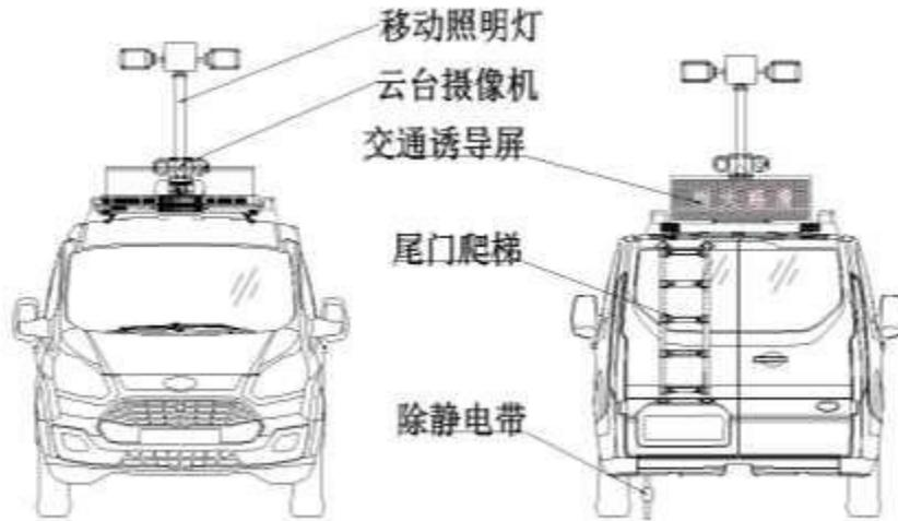
车辆尾部尾门上安装登顶尾门爬梯，方便人员登高车顶拍照等。车辆底部安装防静电带，双开尾门打开，勘察设备从车辆尾部拿取。
