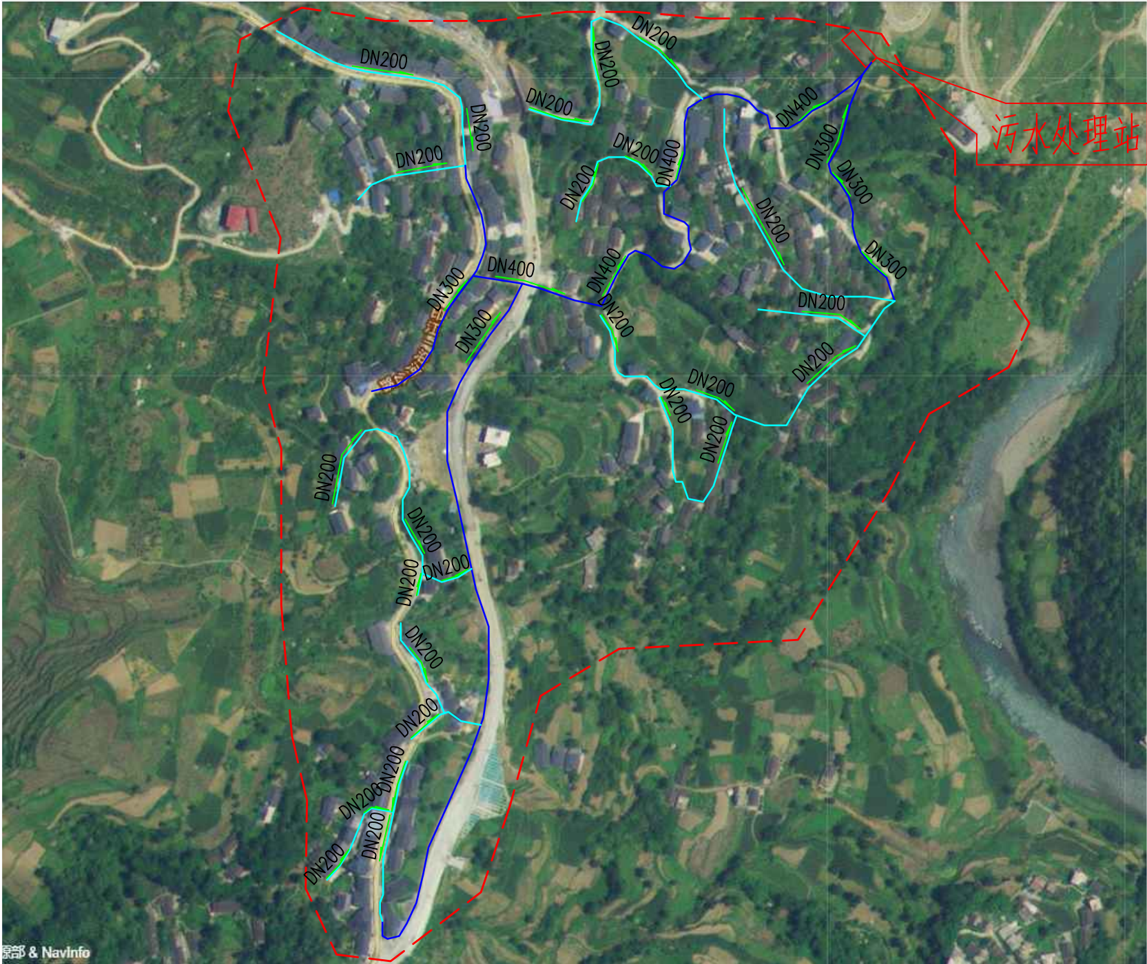
淇滩镇—天宫井村农村污水处理管网平面布置图75m³/d
