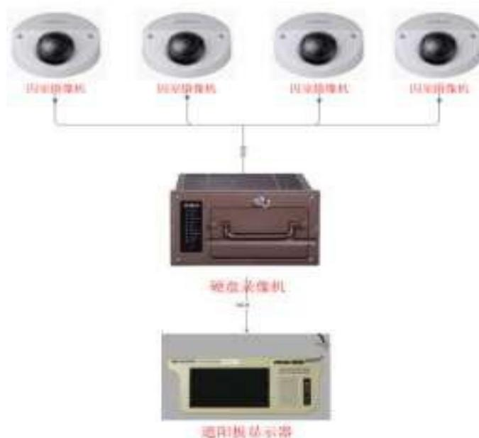
监控系统由高清监控摄像机、高清硬盘录像机和监视器组成。高清监控摄像机所采集的音、视频数据可被高清硬盘录像机压缩并存储，同时视频可由高清硬盘录像机实时解码，在监视器上播放出来。
